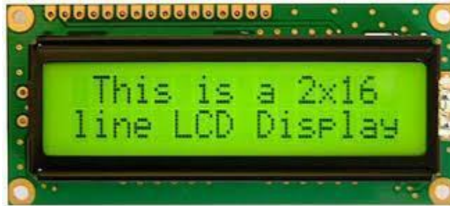
Fig. 7.26 Pantalla de Cristal Líquido (LCD – Liquid Crystal Display) 2 x 16
