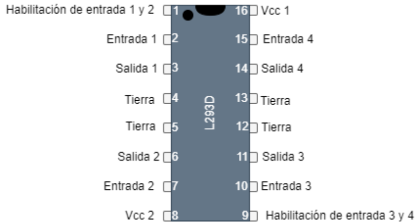
Fig. 3.11 Diagrama de pines puente H (L293D)
